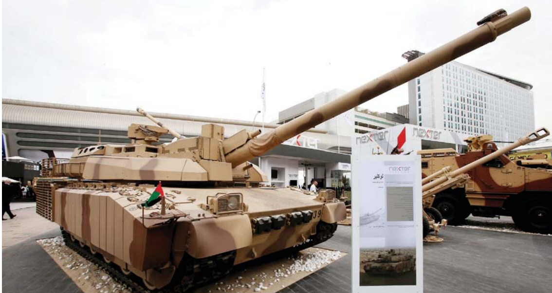
تزويد الدبابة لوكيرك بنظام «أزور» لحماية درعها من القذائف والصواريخ
