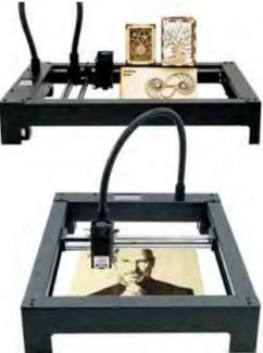
تستطيع آلة «إكس بلوتر» -التي تم تمويلها عن طريق التمويل الجماعي- إنتاج الرسومات المفصلة بشكل مذهل، حيث صممت الآلة كي تحاكي عمليتي الرسم والكتابة اليدويتين. وتستطيع الآلة رسم أي صورة موجودة على جهاز الكمبيوتر. كما يستطيع رأسها الليزري أن ينقش على عدد متنوع من المواد. وتستطيع «إكس بلوتر» التقاط الأشياء بمساعدة نظام يعمل بمضخة فراغية. ومن المتوقع البدء في طرح هذه الآلة في الأسواق في يوليو المقبل.
