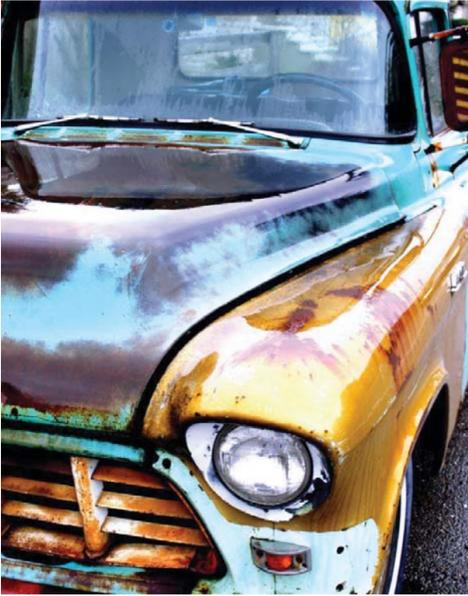
ثمة كثير من الأسباب تقف وراء إصابة هيكل السيارة بالصدا، وربما يكون السبب الأكثر أهمية خدش الطلاء الأساسي للسيارة نتيجة للاحتكاك مع جسم آخر، مما يؤدي لتعرض معدن السيارة للرطوبة والهواء التي في النهاية تسبب الصدا، أو ببساطة فإن عمر السيارة والمنطقة التي كانت مصطفة فيه ساهمت في تكوين الصدا.
